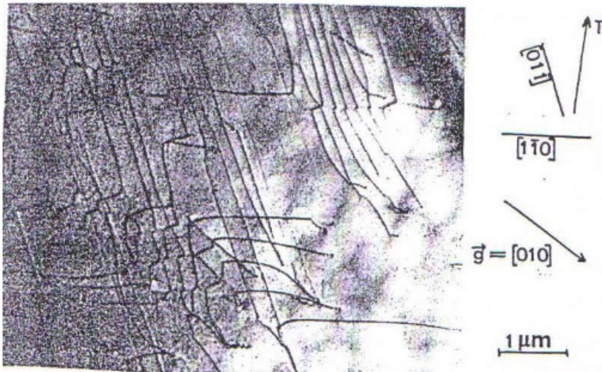
Fig. 4: Observation des dislocations dans un microscope électronique classique. Dû au contraste de diffraction, les dislocations apparaissent sous forme de lignes noires. Echantillon Aluminium, Photo M. Carrard, Thèse EPFL 1985 (Agrand. 15 000 x)
